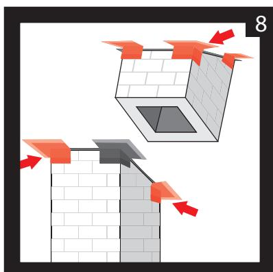
Alle vier WinkelECK Manschetten müssen nach dem gleichen Prinzip angebracht werden. Bitte achten Sie speziell auch auf die angelegten Dachschrägen.
