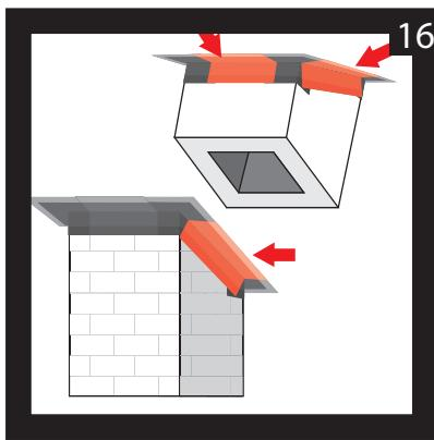
Das Anschlussband muss an allen vier Seiten nach dem gleichen Prinzip verbaut werden.
