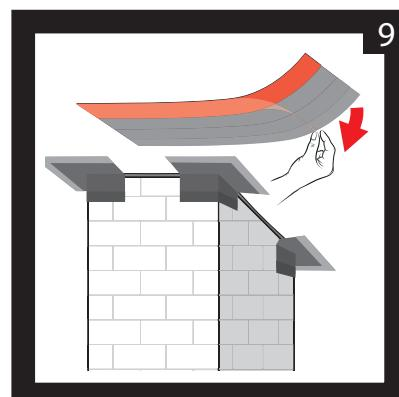
Entfernen Sie die kurzzeitige Schutzfolie des Anschlussbandes.
