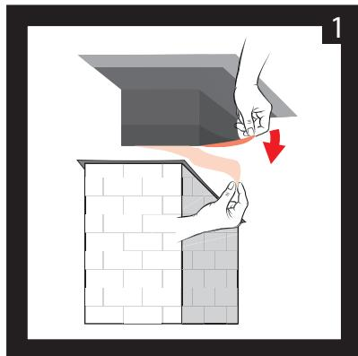
Entfernen Sie die Schutzfolie des obenliegenden Klebekragens.
