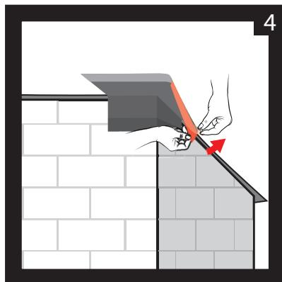
Entfernen Sie den ersten Teil der untenliegenden Schutzfolie des Klebekragens.
