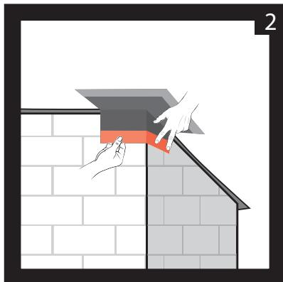
Drücken Sie den Klebekragen flächig an das Bauteil.
