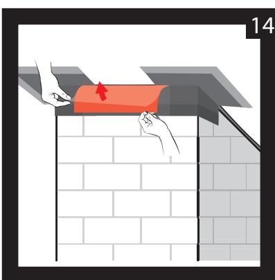
Entfernen Sie den unteren Teil der Schutzfolie des Anschlussbandes.
