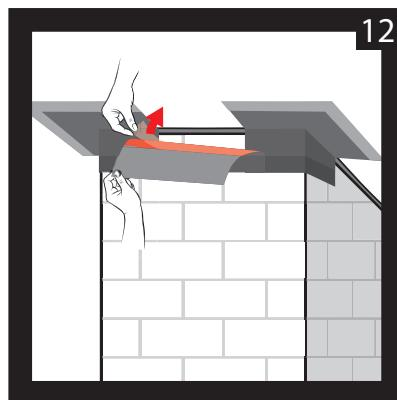
Entfernen Sie die mittig liegende Schutzfolie von dem Anschlussband.
