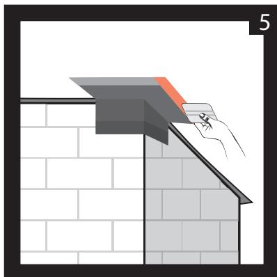
Die Klebefläche mit einem festen Hilfsmittel, z.B. Rakel, auf dem Bauteil andrücken.
