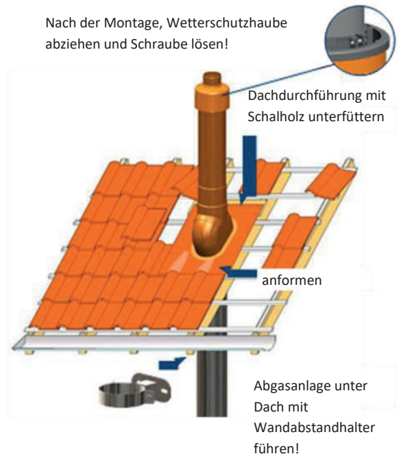
typische Schrägdachdurchführung mit Dachheizzentrale
