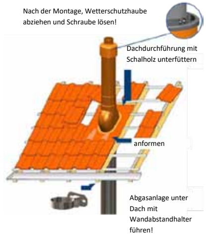
typische Schrägdachdurchführung mit Dachheizzentrale
